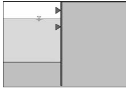
Abb. 2.4: Mehrfach verankerte Spundwände [BRINKMANN, 2005]
