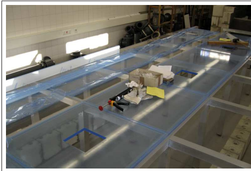
(a) Verlegung der Plexiglasplatten
