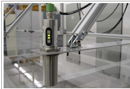
(c) Befestigung der Ultraschallsensoren
