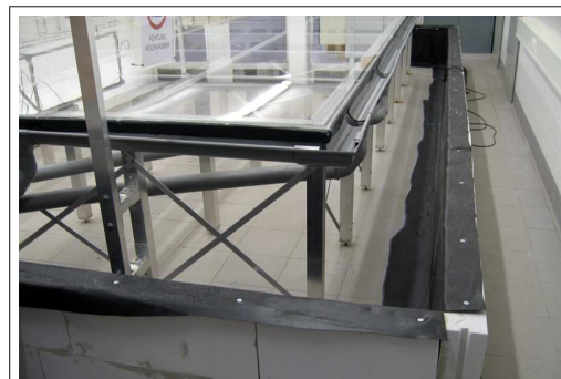
(f) Überlaufbehälter rund um das Modell
