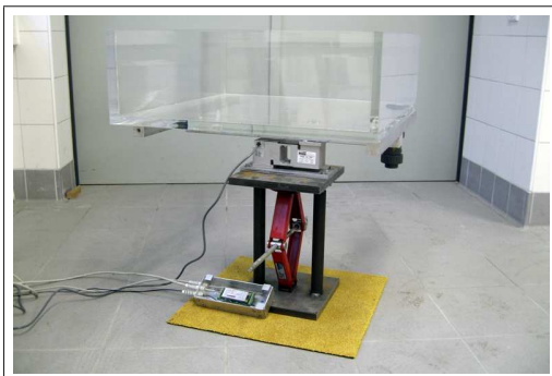
(e) Messaufbau Wägezelle
