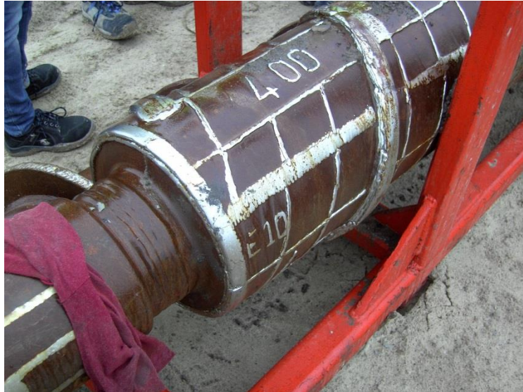
Abbildung 41: Vollverdrängender Bohrer mit einem Durchmesser von 400 mm
