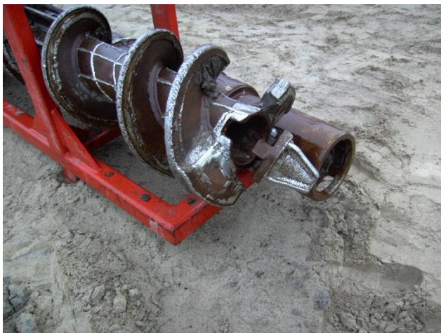
Abbildung 40: Bohrkopf mit abklappbarer Spitze
