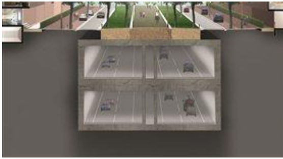
Abbildung 13: Querschnitt des doppelstöckigen Tunnels (Quelle: http://www.a2maastricht.nl/data/fotos/alg/id1720/x0y548w277h153cw1224ch680_ft1720.jpg )
