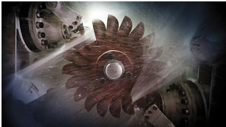
Abbildung 2-3 Pelton-Turbinenlaufrad mit 2 Düsen (4)
