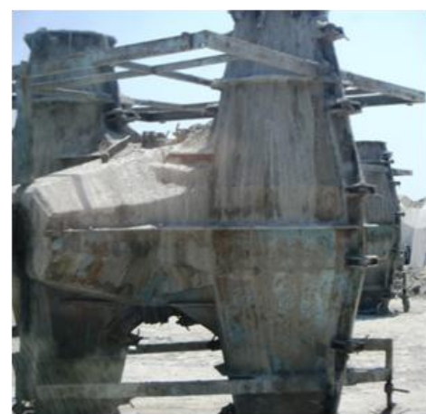
Abbildung 16 – Schalung der „Dolos“
