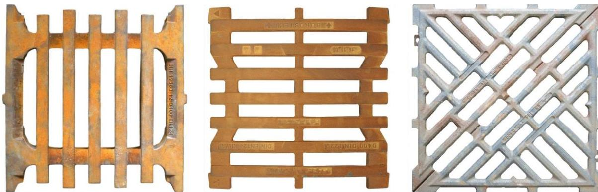
**Abbildung 3:** Untersuchte Straßenablauf-Aufsätze, Fließrichtung von links nach rechts (links: Querstreben (PA\_Q), mitte: Längsstreben (PA\_L), rechts: Diagonalstreben (PA\_D))
