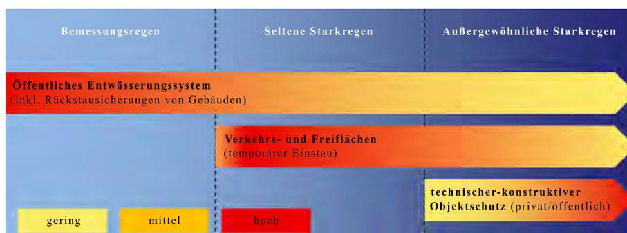
Abbildung 3.4: Elemente des Überflutungsschutzes nach DWA (2008) und BWK (2013)
