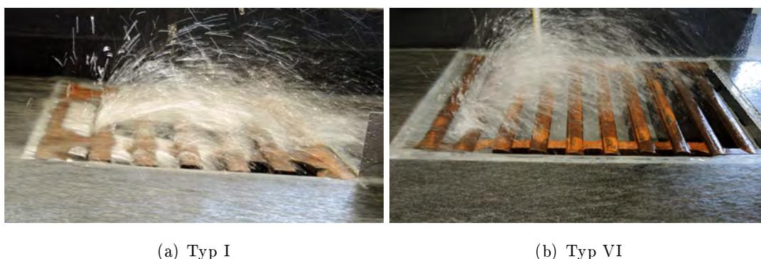
**Abbildung 11.11:** Nahaufnahme der Strömung am Pultaufsatz im physikalischen Modell (ML245-I/VI) zur Untersuchung des Einflusses der Aufsatzlänge auf die typspezifische Effizienz
