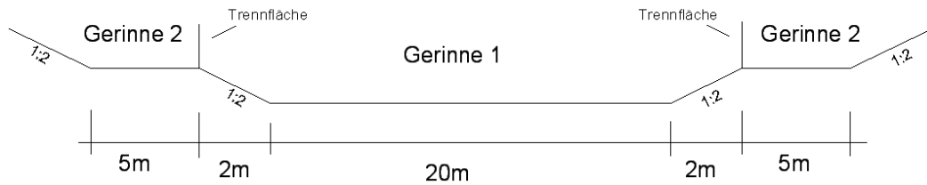
Abbildung 14.5: Gerinnequerschnitt mit Trennflächen
